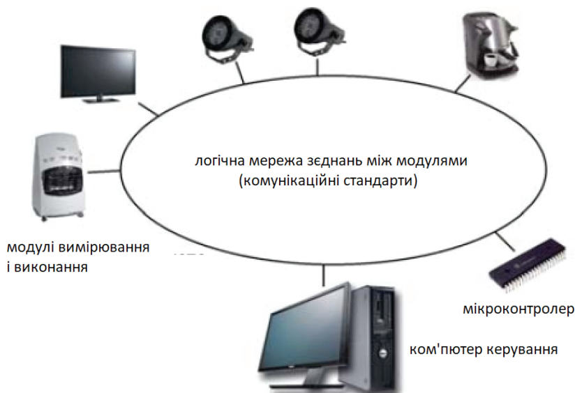
Рис. 1. Типова архітектура системи «розумного будинку»
