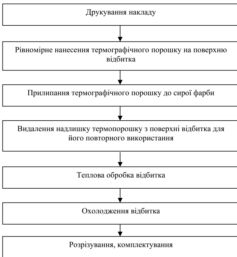
Рис.2. Узагальнена блок-схема технологічного процесу термографічного друку
