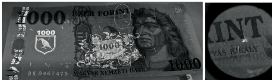
Рис. 4. Захисний елемент «конфетті», який світиться під УФ-світлом
