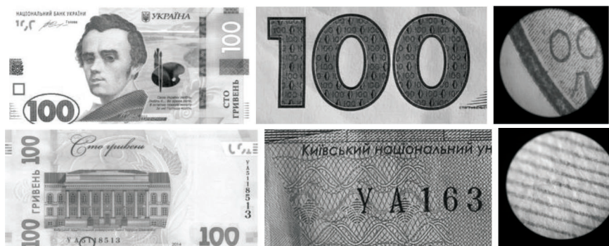
Рис. 8. Приклади захисних елементів, надрукованих орловським друком
