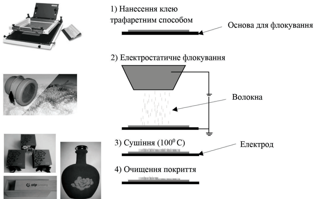
Рис. 5. Технологічний процес флокування за допомогою ручного флокатора:
