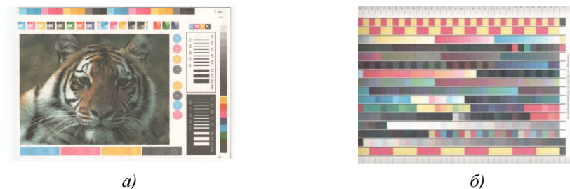
Рис.1. Сканування флокованого матеріалу : відбиток (а) і контрольна шкала (б), віддруковані офсетним способом.
