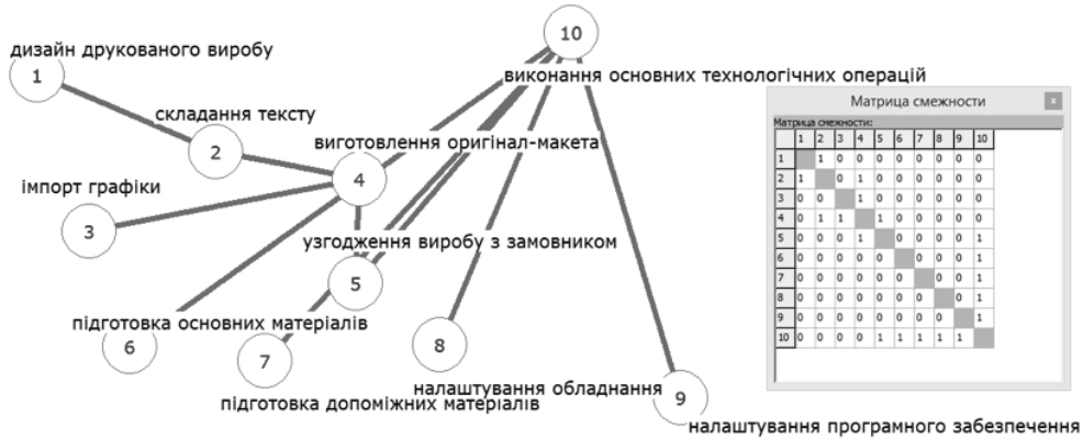
Рис. 1. Граф збільшеного технологічного процесу виготовлення друкованого видання
