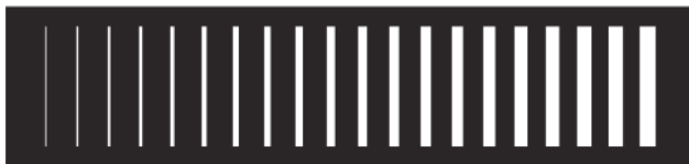
Рис. 2. Контрольна шкала якості зображення ширини штрихів в світлих ділянках на оригіналі
