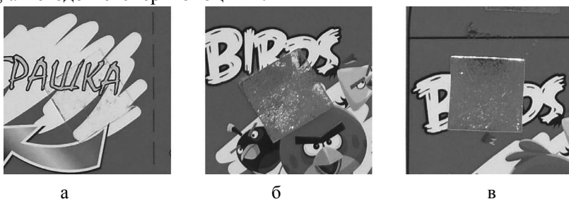
Рис. 5. Відбиток, тиснений фольгою № 1 із силою притиску P = 62,5 \text{ кг/см}^2 за температурних режимів: а) — 30 \text{ }^\circ\text{C} ; б) — 60 \text{ }^\circ\text{C} ; в) — 90 \text{ }^\circ\text{C} відповідно
