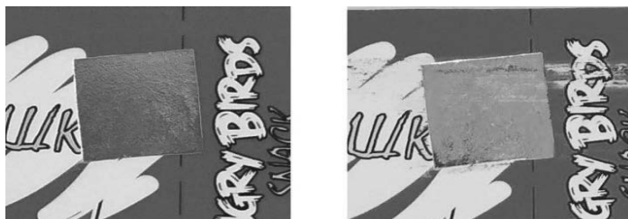
Рис. 7. Відбиток, тиснений фольгою № 1 за температури T = 90\text{ }^{\circ}\text{C} і з силою притиску P = 103,7\text{ кг/см}^2 : а) — до стирання; б) — після стирання
