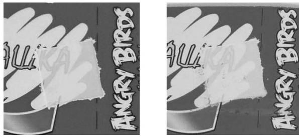
Рис. 9 Відбиток, тиснений фарбовою фольгою № 2 за температури T = 90\text{ }^{\circ}\text{C} і з силою притиску P = 103,7\text{ кг/см}^2 :
