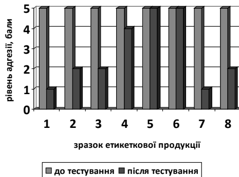
Рис. 4. Діаграма вимірювання рівня адгезії маркування на етикетках: 1 — Морозиво «1965»; 2 — «Вареники»; 3 — Морозиво «Корівка»; 4 — Морозиво «Лід»; 5 — самоприклеювальна етикетка; 6 — пластикова кришка 1; 7 — пластикова кришка 2; 8 — Морозиво «Каштан»
