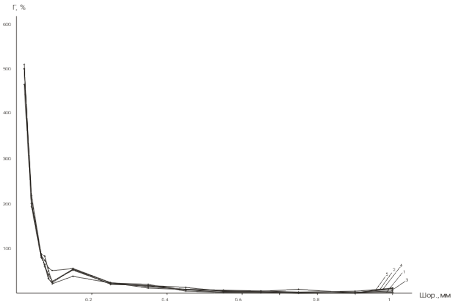
Рис. 8. Графічні спотворення у системі «оригінал-відбиток» (зворотнє зображення): 1 – 85°C; 2 – 90°C; 3 – 95°C; 4 – 100°C; 5 – 105°C
